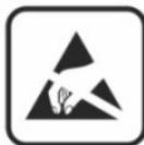
La riparazione del modulo o sostituzione di componenti danneggiati deve essere effettuata dal Costruttore. Il prodotto è sensibile alle scariche elettrostatiche, prendere le opportune contromisure durante qualsiasi operazione.
