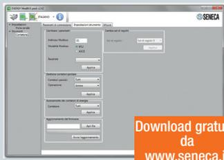
I modelli con comunicazione Modbus possono essere configurati tramite il pacchetto software ENERGY MODBUS PACK scaricabile da [www.seneca.it](http://www.seneca.it).
