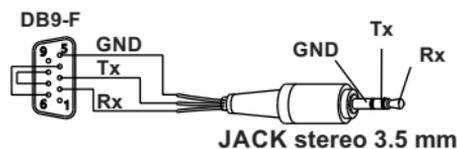
La porta COM frontale è utilizzata solo per programmare lo Z-LINK1. Il cavo di connessione DB9-Jack stereo 3.5 mm può essere assemblato come indicato nella figura a lato, oppure acquistato come accessorio.
