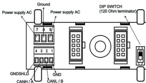
Nel caso di utilizzo dell'accessorio Z-PC-DINAL2-17,5, i segnali possono essere forniti tramite morsettiere. In figura si riporta il significato dei vari morsetti e la posizione del DIP-switch (presente in tutti i supporti per guida DIN elencati in Accessori) per la terminazione della rete CAN (non usata nel caso di rete Modbus). GND SHLD: Schermo per proteggere i cavi di connessione (consigliato).
