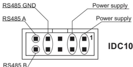
In figura si riporta il significato dei vari pin del connettore IDC10 nel caso in cui si desideri fornire i segnali direttamente tramite esso.
