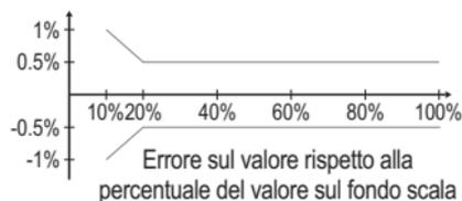
L'errore totale è la somma dell'errore del trasduttore Rogowski con l'errore del modulo.
