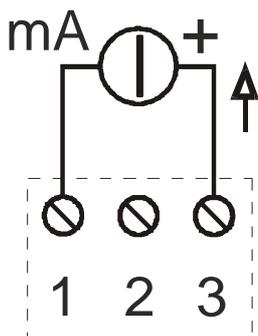
**AKTIVER AUSGANG:** Der Trennwandler generiert einen Strom in der Ausgangsstromschleife identisch zu dem Eingangssignal. Es kann eine maximale Last von 500 Ohm angeschlossen werden.
