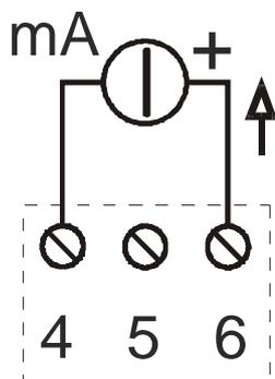
**AKTIVER AUSGANG:** Der Trennwandler generiert einen Strom in der Ausgangsstromschleife identisch zu dem Eingangssignal. Es kann eine maximale Last von 500 Ohm angeschlossen werden.
