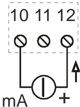
**PASSIVER EINGANG:** Verbinden Sie den Trennwandler mit der Stromschleife gemäß Bild. Der Trennwandler wird über die 4-20 mA Stromschleife gespeist.
