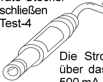
Die Stromversorgung des Test-4 erfolgt über das mitgelieferte Netzteil 5 VDC @ 500 mA, das über den Jack-Stecker an das Test-4 angeschlossen wird.
