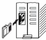
Einsetzen der MicroSD oder der microSDHC in den seitlichen Slot. max. 32 GB. Push-Push Steckverbindung für Einsetzen und Entfernen.
