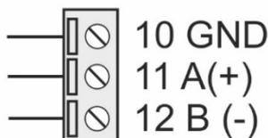
Z-TWS11 a un port série. Il peut être configuré avec le commutateur SW2. Si le commutateur SW2 est réglé sur désactivé OFF ↓, aux bornes 10-11-12 est disponible le port RS485 COM 4. La figure indique comment faire la connexion.
