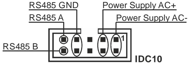
Es ist keine Isolierung zwischen RS485 und dem rückübertragenen Ausgang vorhanden.
