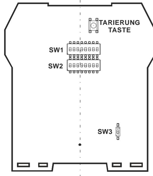
Für die Benutzung der seitlichen Tariervorgangstaste den DIP-Switch 1 von SW2 in die Position OFF setzen.
