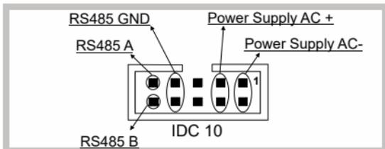
En la figura se reproduce el significado de los varios pin del conector IDC10 en caso en que se desee suministrar las señales directamente mediante el mismo.
