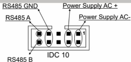
La figure reporte la signification des différentes broches du connecteur IDC10 pour pouvoir éventuellement fournir les signaux directement à l'aide de ce dernier.
