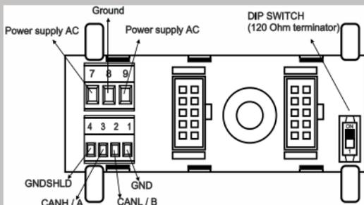
En cas d'utilisation de l'accessoire Z-PC-DINAL2-17.5, les signaux peuvent être fournis à l'aide de borniers. La figure reporte la signification des différentes bornes et la position du commutateur (présent dans tous les supports pour guide DIN énumérés dans les Accessoires) pour la terminaison du réseau CAN (pas utilisé en cas de réseau Modbus). GNDSHLD : Blindage pour protéger les câbles de connexion (conseillé).
