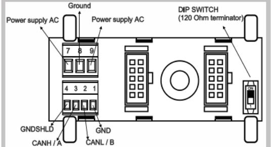
En cas d'utilisation de l'accessoire Z-PC-DINAL2-17.5, les signaux peuvent être fournis à l'aide de borniers. La figure reporte la signification des différentes bornes et la position du commutateur (présent dans tous les supports pour guide DIN énumérés dans les Accessoires) pour la terminaison du réseau CAN (pas utilisé en cas de réseau Modbus). GNDSHLD : Blindage pour protéger les câbles de connexion (conseillé).
