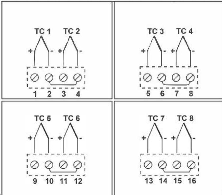
Le module accepte en entrée des thermocouples de type : J, K, E, N, S, R, B, T. Pour les branchements électriques, il est conseillé d'utiliser le câble blindé. Les paires de canaux faisant partie du même groupe de bornes ont le terminal de masse connecté intérieurement et ne sont pas isolés les uns des autres. Une isolation de 1,5 kV entre les canaux relatifs aux groupes de bornes différentes est au contraire garantie. Le branchement des bornes est mis en évidence sur la figure ci-contre.
