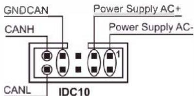
La figure reporte la signification des différentes broches du connecteur IDC10 pour pouvoir éventuellement fournir les signaux directement à l'aide de ce dernier.
