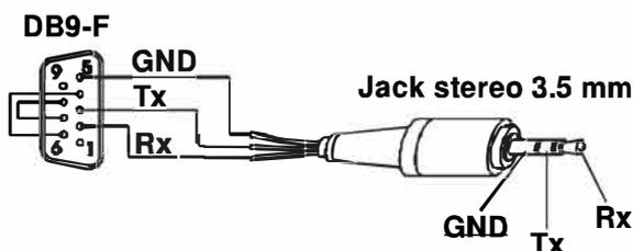
Le câble de connexion DB9 Jack stéréo 3,5 mm peut être assemblé comme indiqué sur la figure ou acheté comme accessoire.
