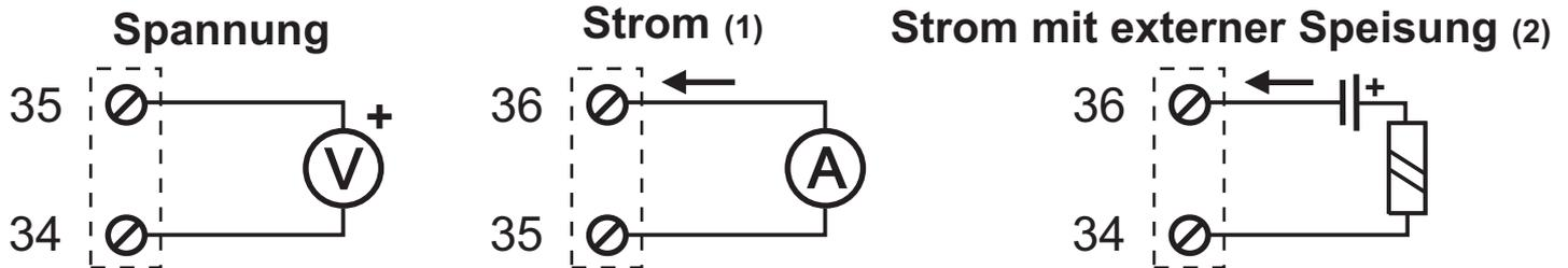
Es ist keine Isolierung zwischen RS485 und dem rückübertragene Ausgang vorhanden.
