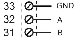
Es ist keine Isolierung zwischen RS485 und dem rückübertragenen Ausgang vorhanden.
