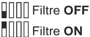
En cas de fréquence à l'entrée peu stable, il est possible d'insérer un filtre pour stabiliser le signal à la sortie. Pour insérer ce filtre, il suffit de positionner le commutateur n° 1 de SW6 sur ON (le déplacer vers le haut).
