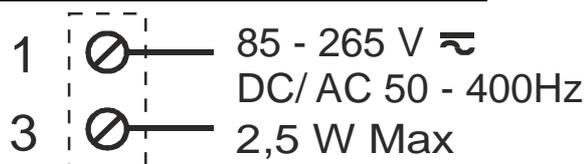
Die Versorgungsspannung muss zwischen 85 und 265 Vcc/Vac (unabhängig von der Polarität), 50 und 400 Hz; siehe auch im Abschnitt **INSTALLATIONSVORSCHRIFTEN**.
