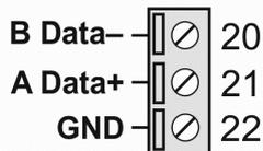
Lo S21N1 ai morsetti 20 – 21 - 22 mette a disposizione una porta seriale RS485 per la comunicazione con il sistema master Modbus. La figura mostra come realizzare il collegamento.
