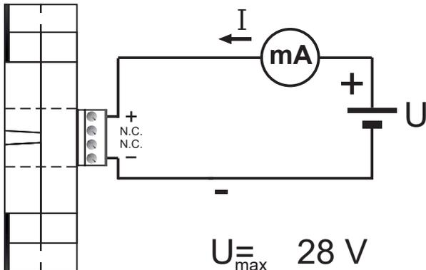
Il est possible de raccorder directement sur la boucle 4 ÷ 20 mA à la sortie du T201DC100 une tension maximale de 28 V.
