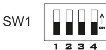
Pour utiliser l'entrée en courant, le commutateur correspondant doit être mis sur ON. La résistance de 100 ohm permet de convertir le signal 4..20mA en une tension 0.4..2 V que le module arrive donc à lire.
