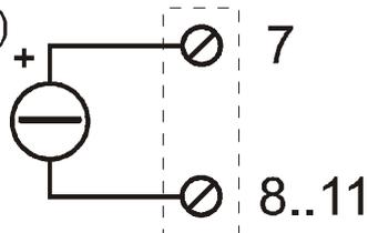
Branchement pour capteur passif (2 fils) 4..20 mA. (\*)
