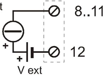
Branchement de capteurs passifs (2 fils) 4..20 mA alimentés extérieurement. (\*)
