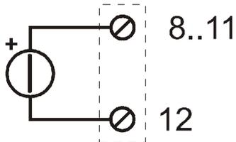
Branchement de capteurs avec sortie en tension jusqu'à +/-10 Vcc.
