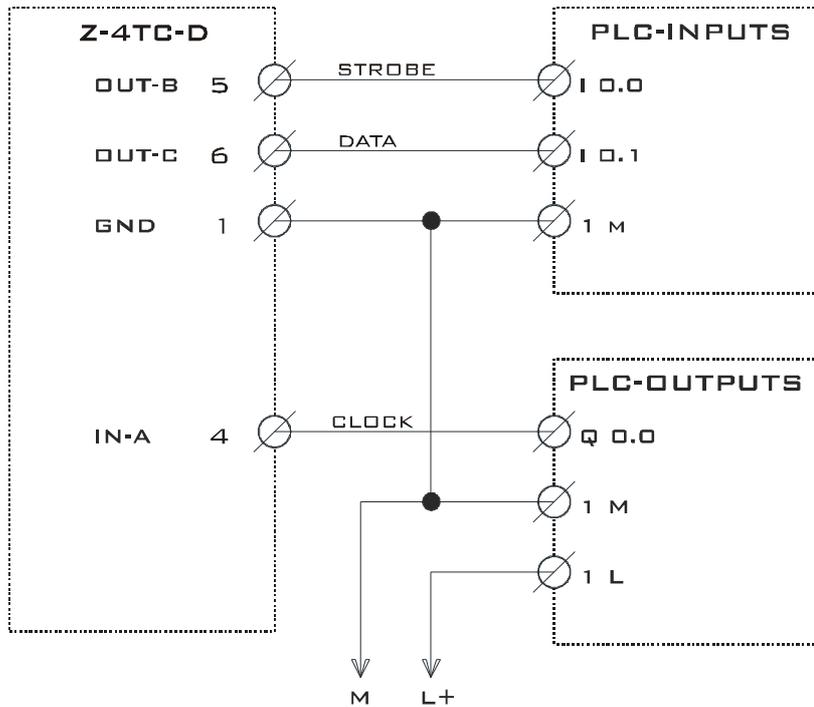
Les branchements indiqués se réfèrent en particulier à un PLC SIEMENS S7-200 CPU 224-CC/CC/CC. Il est en tout cas possible d'utiliser d'autres PLC à condition que les entrées soient assez rapides ( $< 2$  ms) et les sorties soient de type transistor (pas à relais).
