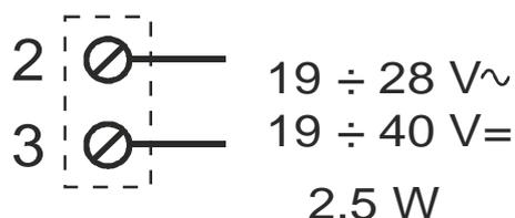
La tension d'alimentation doit être comprise entre 19 et 40 Vcc (peu importe la polarité) ou 19 et 28 Vca ; voir également la section NORMES DE MONTAGE.
