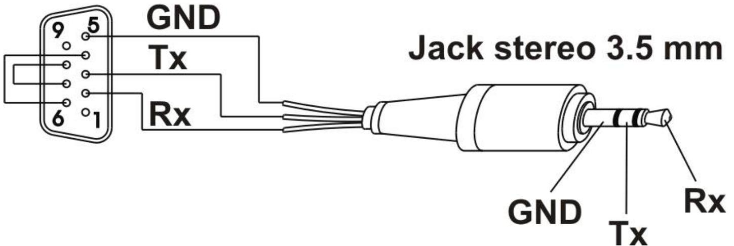
Schéma de réalisation du câble Z-PC pour la programmation avec l'ordinateur. Le câble peut être demandé comme accessoire (code PM001600).
