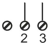
La tension d'alimentation doit être comprise entre 9 et 40 Vcc (peu importe la polarité) ou 19 et 28 Vca ; voir également la section NORMES DE MONTAGE. Les limites supérieures ne doivent pas être dépassées, sous peine d'abîmer sérieusement le module. Il est nécessaire de protéger la source d'alimentation contre les pannes éventuelles du module à l'aide d'un fusible ayant des dimensions appropriées.
