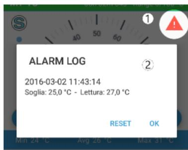
Al superamento della soglia stabilita un'icona lampeggiante indica che è presente un allarme ovvero che è stata superata una soglia. In questa fase, se impostato, il vostro dispositivo provvederà con l'invio dell'SMS di notifica ai destinatari. In questa fase il dispositivo non provvederà al reinvio di ulteriori sms finchè l'allarme non sarà "riarmato". Cliccando sull'icona 1) è possibile scorrere lo storico degli allarmi. Con il tasto reset è possibile resettare/riarmare la funzione allarme.
