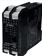
Modulo misto 4 ingressi digitali, 2 ingressi analogici, 2 uscite digitali, ModBUS RTU / ModBUS TCP-IP
