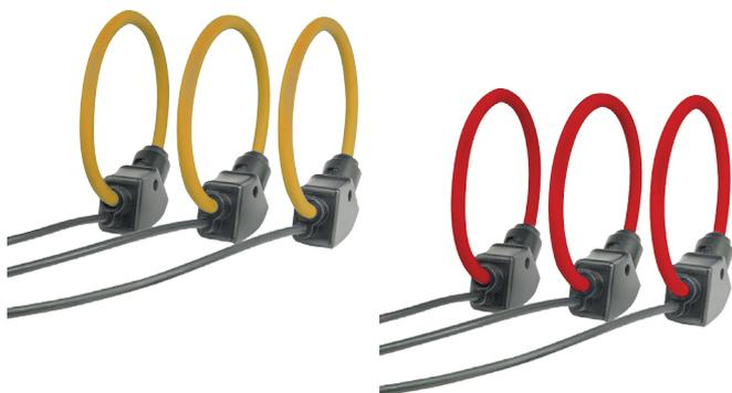
Adatte alla misurazione di correnti da mA a centinaia di kA, le serie RC150 e RC190 assicurano elevata linearità, ampia gamma dinamica e sono molto utili con conduttori grandi o di forma irregolare. La leggerezza e la flessibilità li rendono ottimali anche in luoghi con accesso ridotto.
