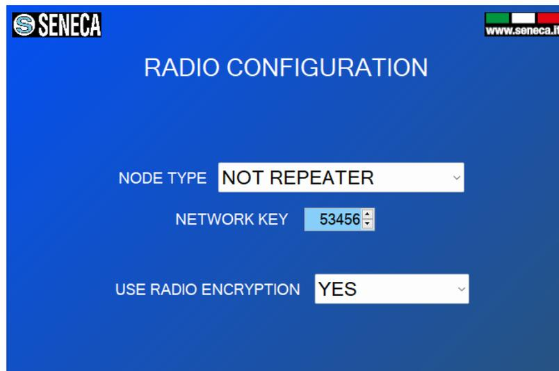
È possibile scegliere se il dispositivo è di tipo repeater (ripetitore), la chiave di rete e se i pacchetti radio sono criptati.
