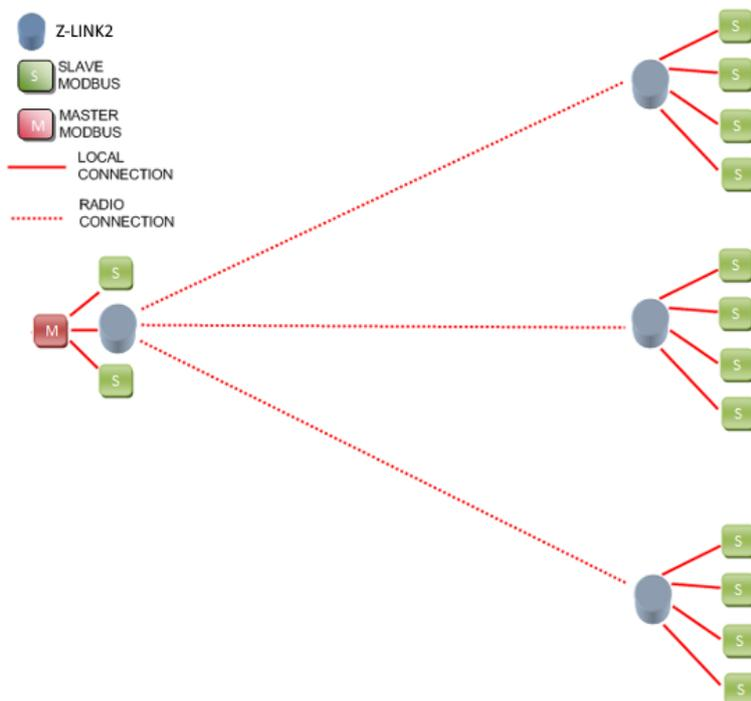
Se uno Z-LINK2-LO non è facilmente raggiungibile è possibile configurarne uno come “repeater”, si noti come anche al repeater sia possibile collegare dei dispositivi Modbus RTU Slave:
