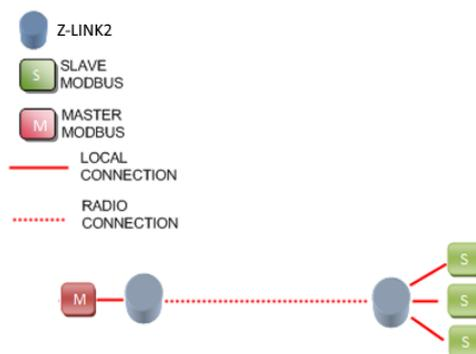
Inoltre, è possibile collegare 1 master Modbus senza slave Modbus locali (punto-multipunto):
