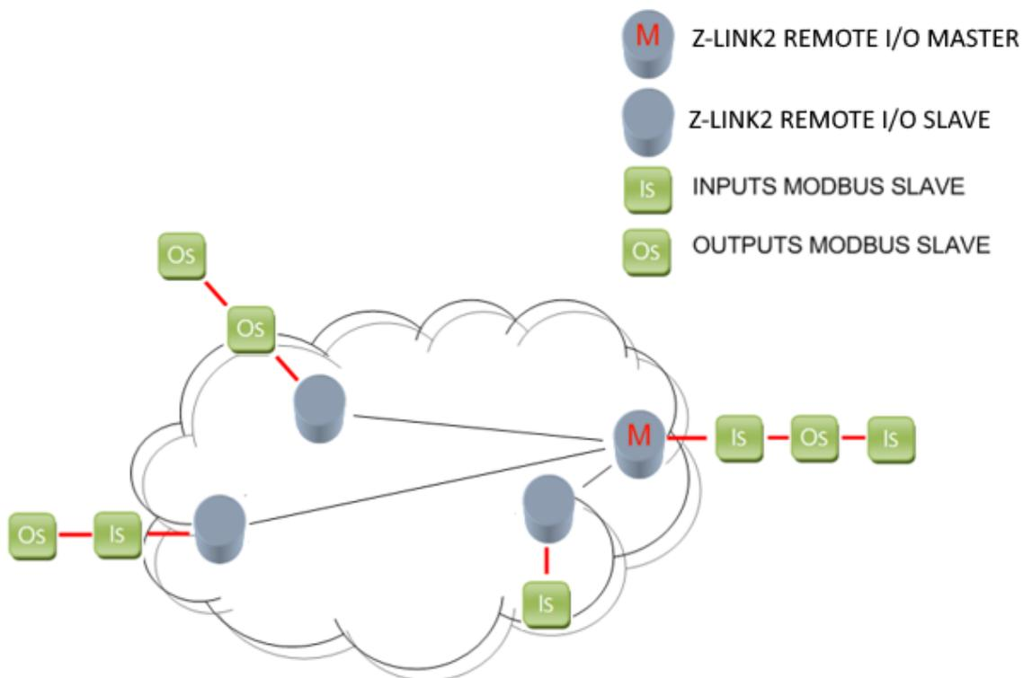
Gli ingressi vengono replicati sulle uscite. Se gli ingressi sono digitali è possibile negarli, se sono analogici è possibile scalarne i valori. Per i requisiti di sicurezza è possibile utilizzare una condizione di guasto.
