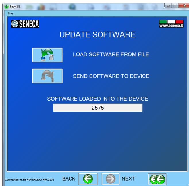
Premendo il pulsante "Load software from file", il software aprirà direttamente la directory del firmware.
