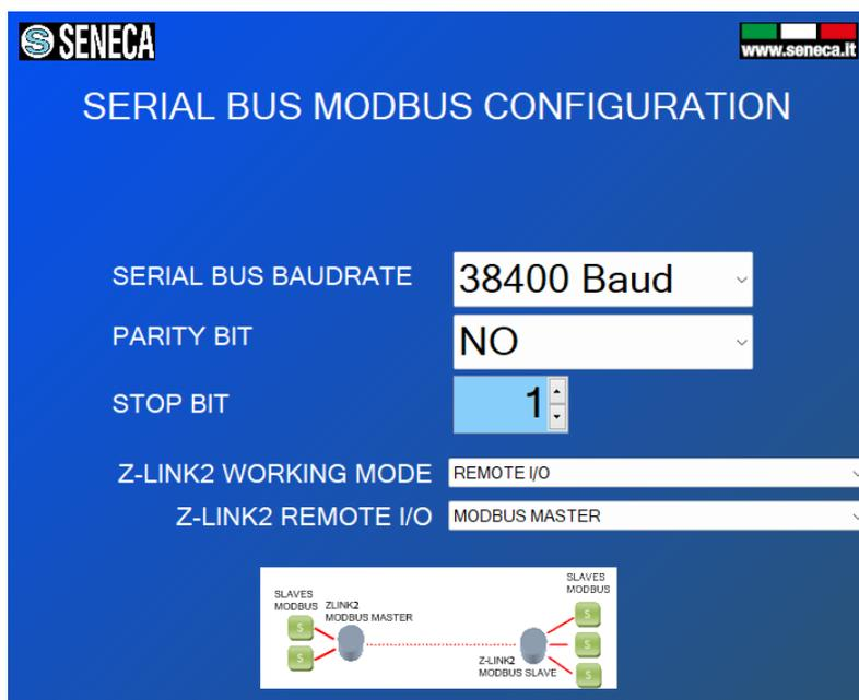
Lo Z-LINK2-LO che funziona da Master Modbus è chiamato "Remote I/O Master Modbus".
