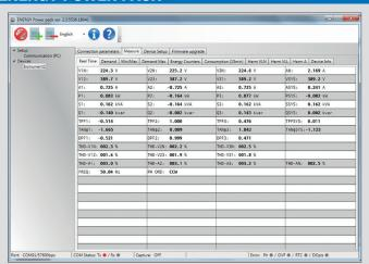
Il pacchetto **ENERGY POWER PACK** è un programma compatibile con tutti i modelli dell'analizzatore di rete S604. Comunica tramite protocollo Modbus RTU e TCP ed effettua la gestione multipla di dispositivi, fino a un massimo di 32. ENERGY POWER PACK assicura la lettura e la visualizzazione di tutte le misure, fornisce un setup completo dei parametri, scarica e converte le registrazioni e gestisce la connessione remota via modem.
