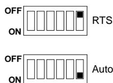
L'interfaccia seriale RS485 è basata su una linea di comunicazione differenziale bilanciata con impedenza tipica di 120 ohm. La lunghezza massima del collegamento non è definita ma dipende dalla velocità di comunicazione, dal rapporto segnale disturbo, dalla qualità del cavo.
