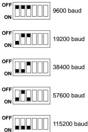
**NOTA** : settare la velocità di comunicazione quando è impostata la commutazione di linea automatica.
