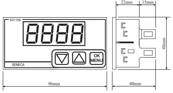
Gewicht: 100 g; Gehäuse: Material PC/ABS selbstlöschend UL94-V0, schwarz.
