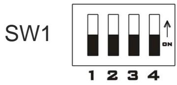
Para utilizar la entrada en corriente el conmutador DIP específico debe estar en posición ON. La resistencia de 100 ohm permite convertir la señal 4..20mA en una tensión 0.4..2 V que, de esta manera, puede ser leída por el módulo.
