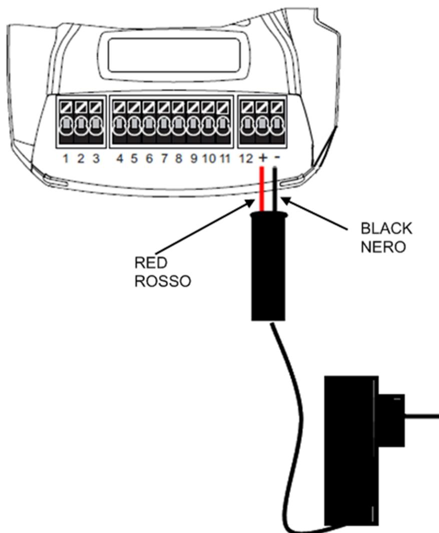
Una volta collegata l'alimentazione MyALARM2 si accenderà, attendere che il led giallo "GSM" lampeggi lentamente e che compaia a display il livello del segnale GSM.
