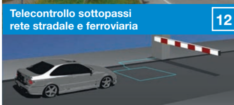
Sistema di rilevamento targhe e transito veicoli
