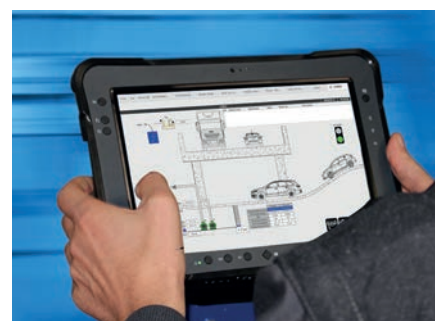
Sinottico di monitoraggio del sottopasso realizzato tramite Scada
