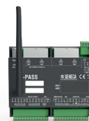
Controllore Straton Edge IIoT con prot. Energia, Wi-Fi, 2 porte LAN
