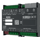
Analizzatore di rete trifase con ingressi per TA, TV, Rogowski, connessione Ethernet, misura THD
