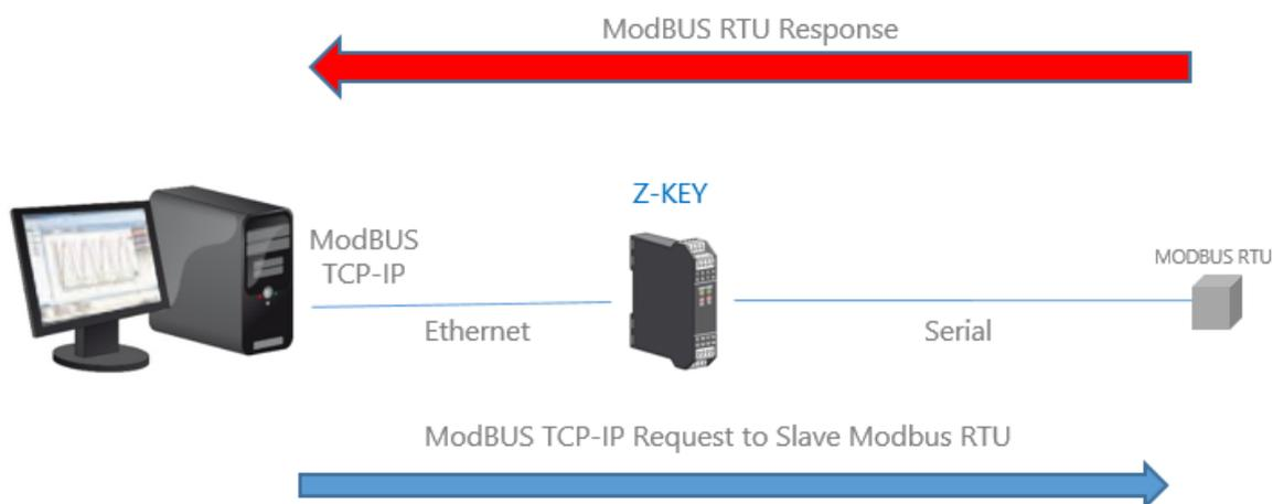
Il Client Modbus TCP richiede la lettura/scrittura di un registro ModBUS via ethernet, il gateway converte la richiesta verso gli slave seriali in Modbus RTU/ASCII e la risposta Modbus RTU/ASCII dello slave interrogato viene successivamente convertita verso il Modbus TCP Client.
