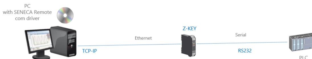
È possibile effettuare anche una connessione via internet (tipicamente per la manutenzione remota di macchine, PLC ecc...):
