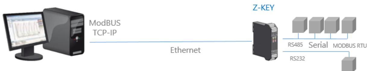
È possibile anche una comunicazione remota attraverso internet con più Client Modbus TCP-IP:
