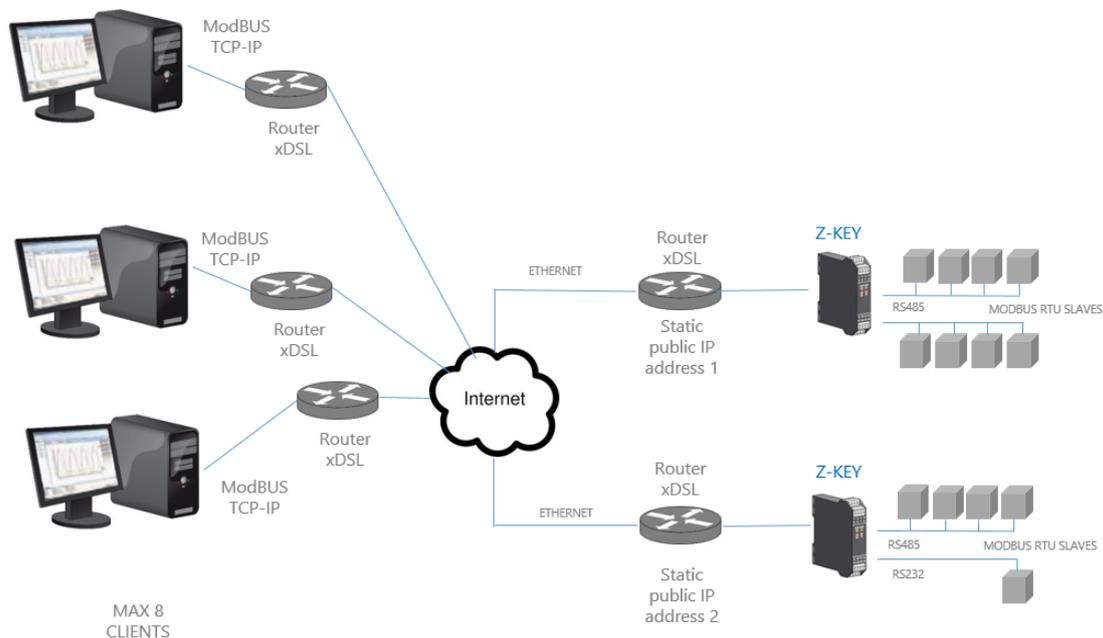
Sono supportati al massimo 8 Client Modbus TCP-IP simultanei.
