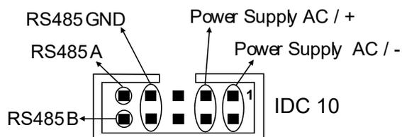
La figure reporte la signification des différentes broches du connecteur IDC10 pour pouvoir éventuellement fournir les signaux directement à l'aide de ce dernier.
