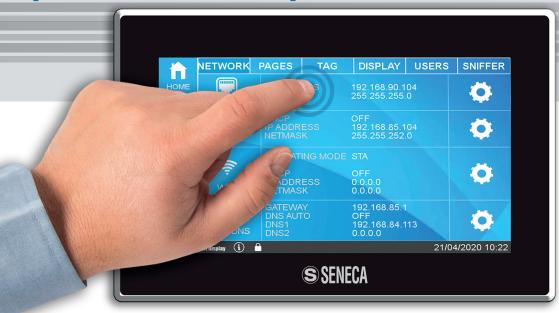
SSD permette la creazione di pagine personalizzate e la configurazione di un progetto di automazione direttamente da touch panel con una ampia libreria di widget disponibili.
