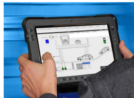
Surveillance synoptique du passage souterrain faite par Scada
