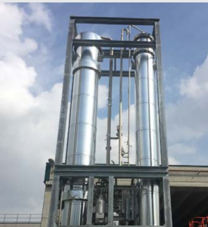
Unité de valorisation GM-GreenMethane de 125 Smc/h de biométhane
