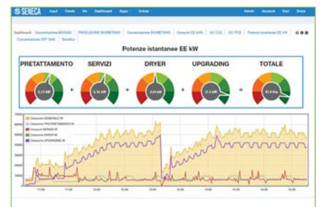
Écran Smart Vision, analyse des puissances instantanées
