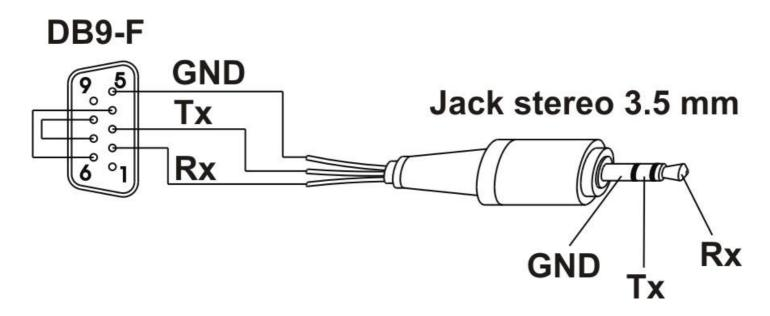
Schéma de réalisation du câble Z-PC pour la programmation avec l'ordinateur. Le câble peut être demandé comme accessoire (code PM001600).
